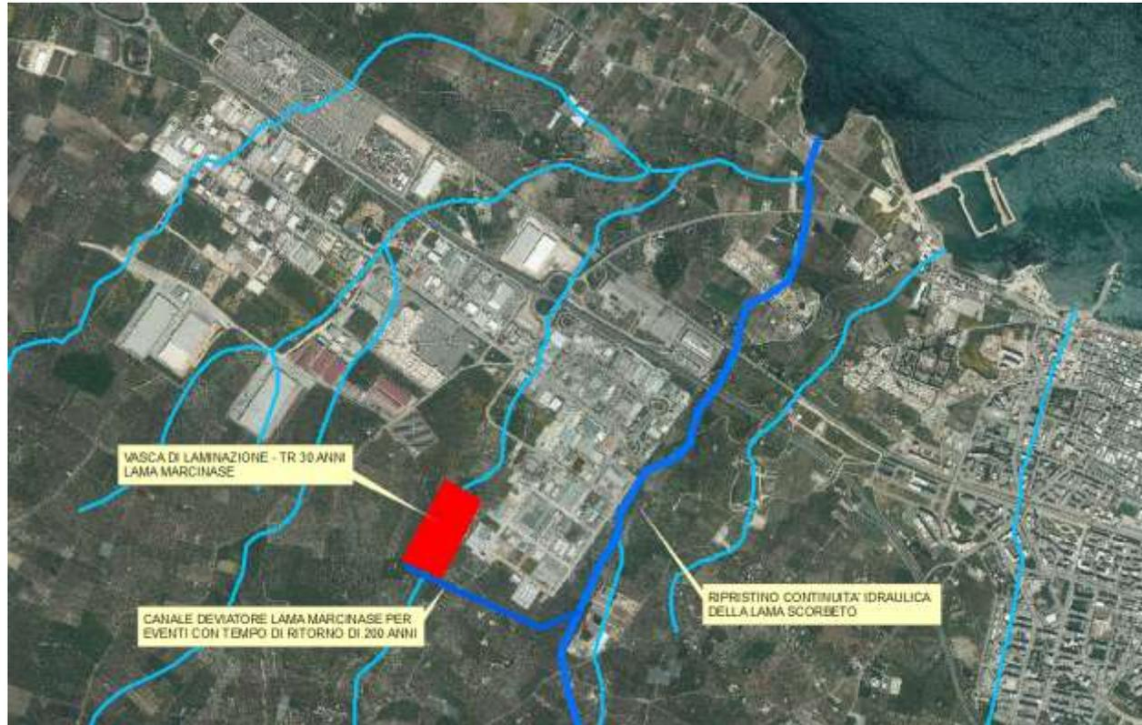
Partendo dalla soluzione n.3, al fine di ridurre le dimensioni geometriche delle opere a farsi lungo l'asse della lama Scorbeto, si prevede di realizzare in asse alla lama Marcinase una vasca di laminazione /bacino di contenimento
