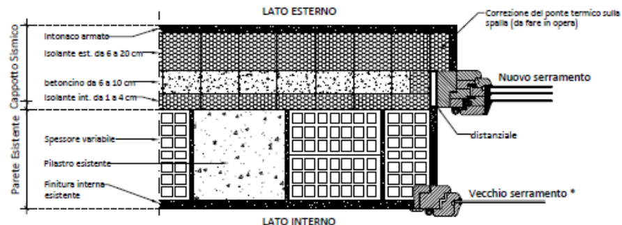
Esempio 2 - Con sostituzione del vecchio serramento
