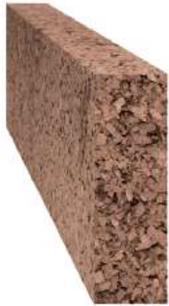
SUG Sughero biondo \lambda_a = 0,044 \text{ W/(mK)} Euroclasse E
