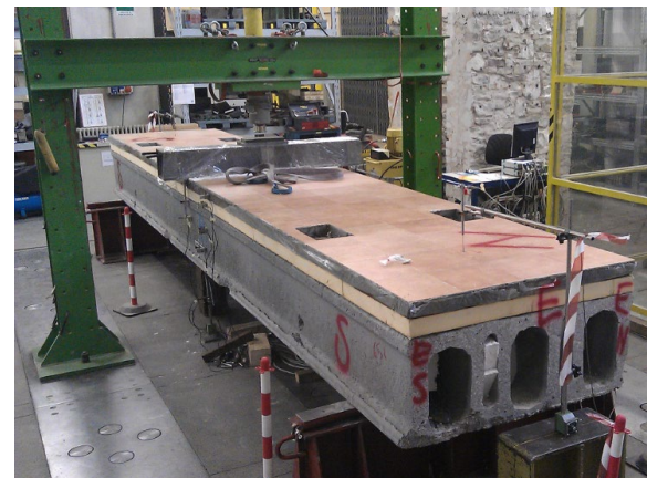
Campione alveolare con finitura in piastrelle
