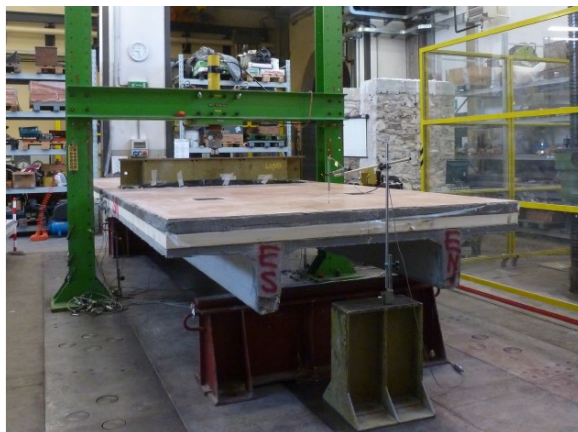
Campione tegolo TT con finitura in piastrelle
