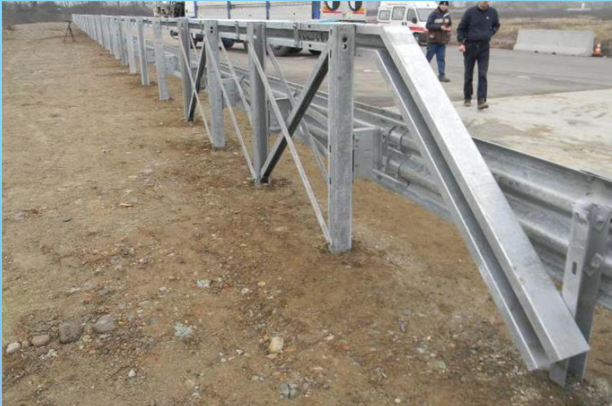
Barriera in condizione di prova con terreno di elevate caratteristiche meccaniche
