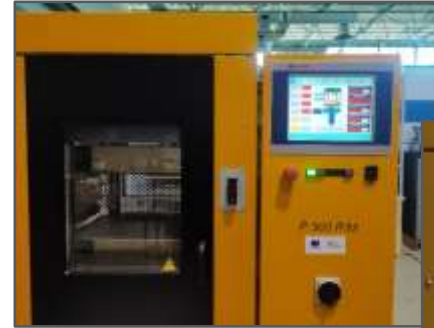
Pressa da laboratorio Collin mod. P 300P/M
