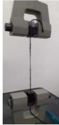
Test trazione su filati
