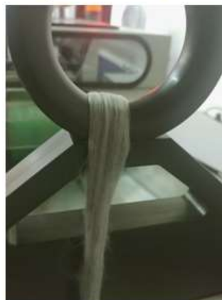
Nastri di fibre fortemente allineate (larghezza \approx 5 cm)
