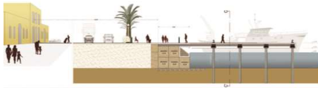
SEZ A-A' - PORTO PESCHERECCIO AVANZAMENTO BANCHINA -
