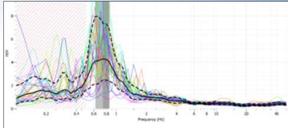
*La differenza tra il valore di frequenza di risonanza del terreno 0,76 Hz e quelle della struttura nella prima frequenza in direzione x paria a 5,08 Hz, la differenza in percentuale è ben al di sopra del 25%, limite al quale viene considerato basso il pericolo di risonanza terreno-struttura [A. Gosar, — Site effects and soil-structure resonance study in the Kobarid basin (NW Slovenia) using microtremors, Nat. Hazards Earth Syst. Sci., 10, 761–772, 2010]*
