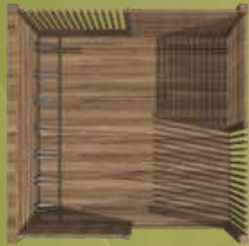
modulo E Modulo adibito a deposito biciclette 2,70 x 2,70 x 2,95 m
