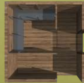
modulo D Modulo adibito a locale tecnico con deposito a servizio delle cucine 2,70 x 2,70 x 2,95 m
