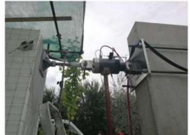
Figura 4.14. Sistema di applicazione del carico per prove cicliche quasi statiche.
