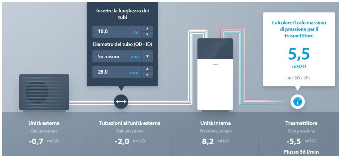
Pipe sizing tool è uno strumento di calcolo necessario per determinare la lunghezza delle tubazioni idroniche tra interna ed esterna a partire dalle perdite di carico sugli emettitori oppure facendo il viceversa ossia nota la lunghezza di connessione tra interna ed esterna determino la pressione residua sugli emettitori.
