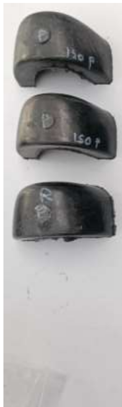
disposizione fibre di carbonio ISOTROPICA (spessore 6 mm)
