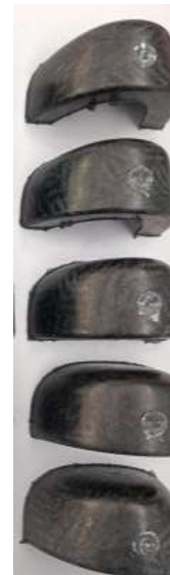
disposizione fibre di carbonio RANDOM (spessore 6,5 mm)
