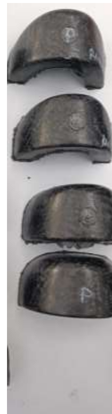
disposizione fibre di carbonio RANDOM (spessore 6 mm)
