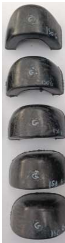
disposizione fibre di carbonio ISOTROPICA (spessore 6,5 mm)
