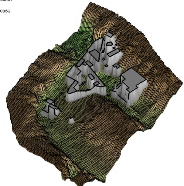
Griglia di calcolo con risoluzione di 5 metri
