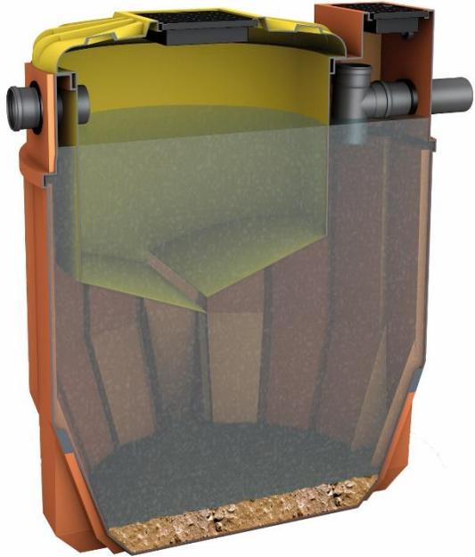
La geometria del manufatto e l'inserimento di setti sagomati al suo interno determina la suddivisione della vasca in scomparti aventi caratteristiche densimetriche ed idrauliche differenti.
