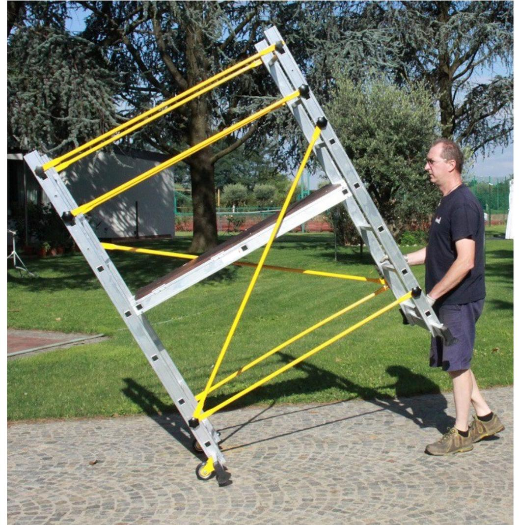
L'attrezzatura dovrà obbligatoriamente essere sottoposta a test di ribaltamento e rigidità oltre a vari test strutturali che prendono in esame tutti i componenti
