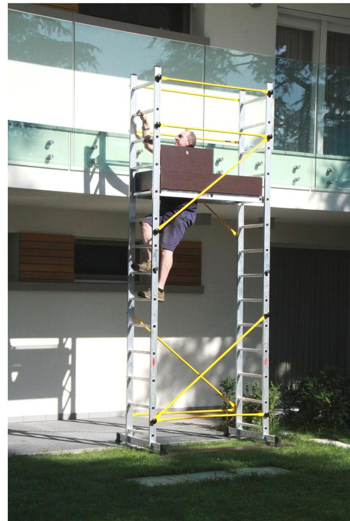
Il piccolo trabattello su 2 ruote, una volta montato, non deve smontarsi accidentalmente nell'uso o negli spostamenti
