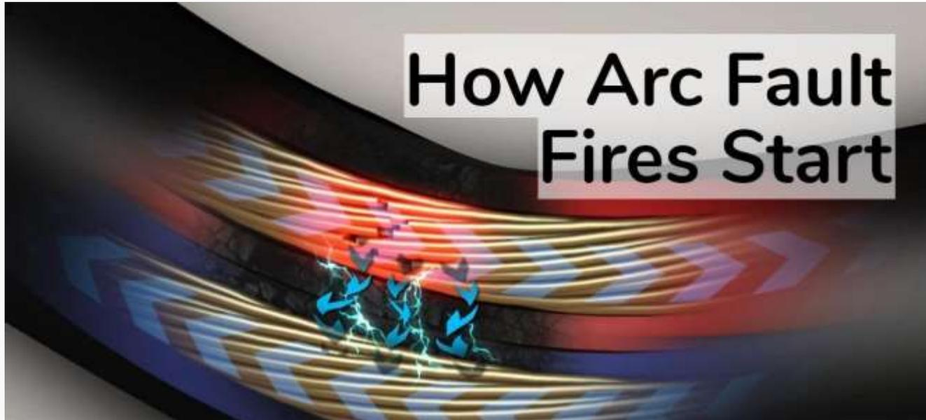
Gli impianti fotovoltaici sono particolarmente vulnerabili nei confronti di questo fenomeno, ***provocato da una interruzione della continuità dei conduttori o da una corrente imprevista tra due conduttori, spesso a causa di un guasto di messa a terra.***
