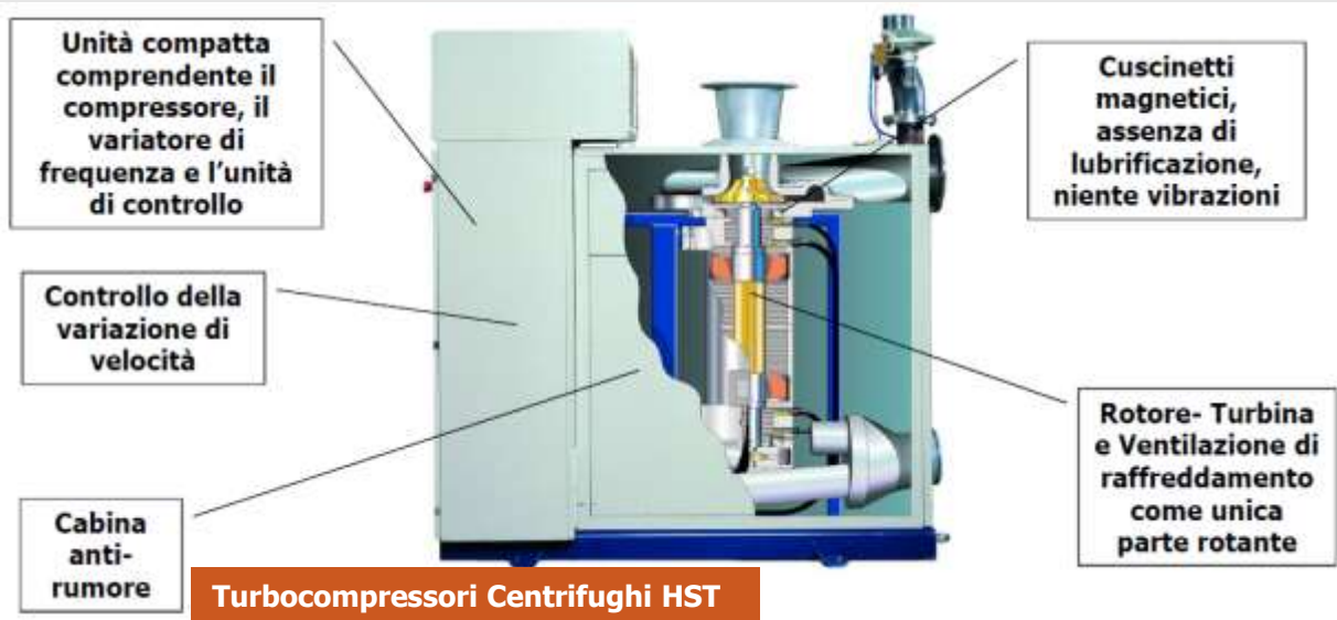
Macchine Centrifughe con distributore fisso
