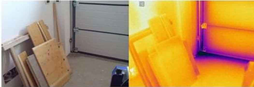
Tuttavia la prova sperimentale legata, ad esempio all'esecuzione di un «Blower door test» evidenzia come i nodi accoppiamento fra elementi portanti del portone e struttura edile siano fondamentali.
