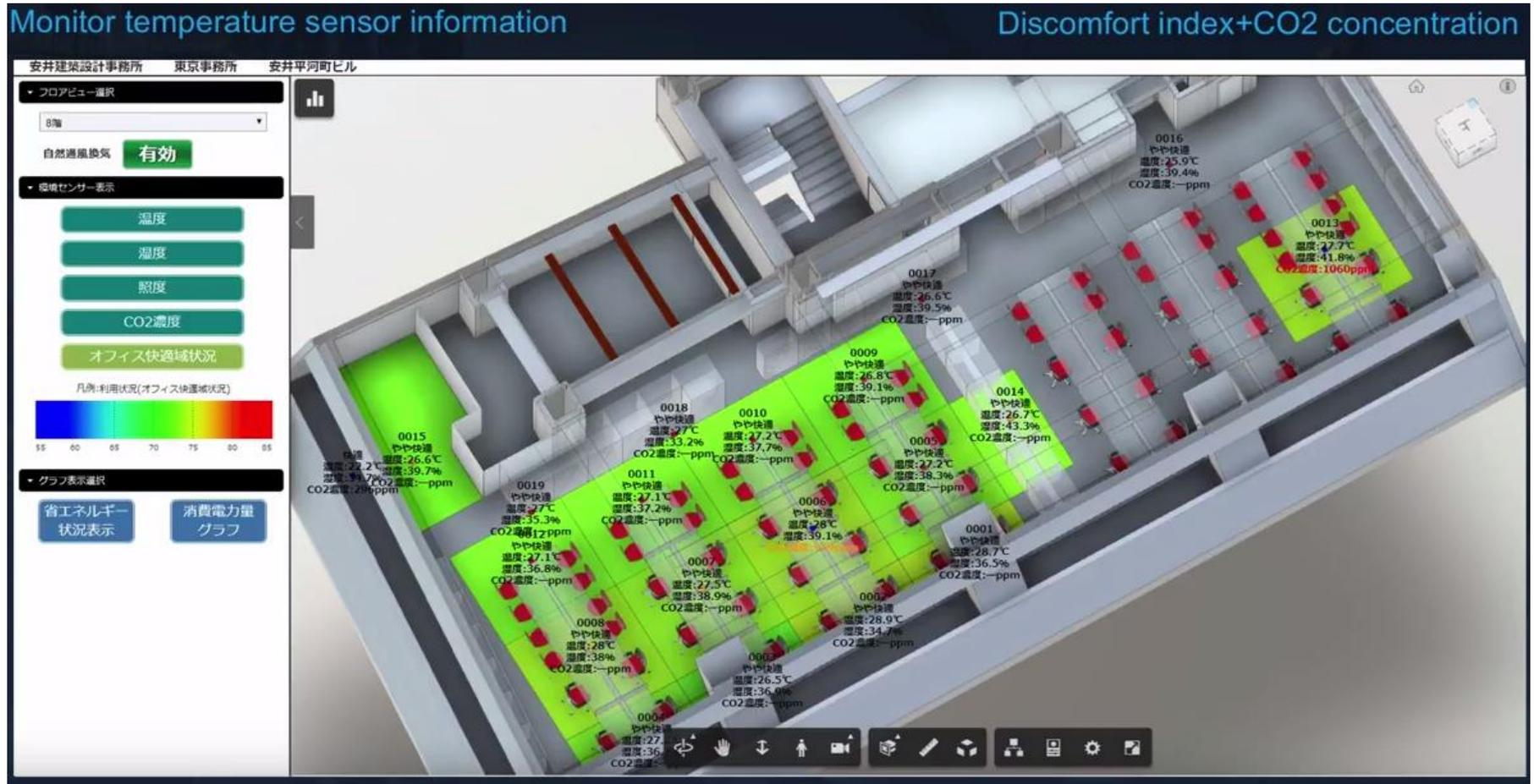
**Visualizzazione dati sensori IOT su modello BIM con sovrapposizione di informazioni sull'occupazione e sui parametri del benessere.**
