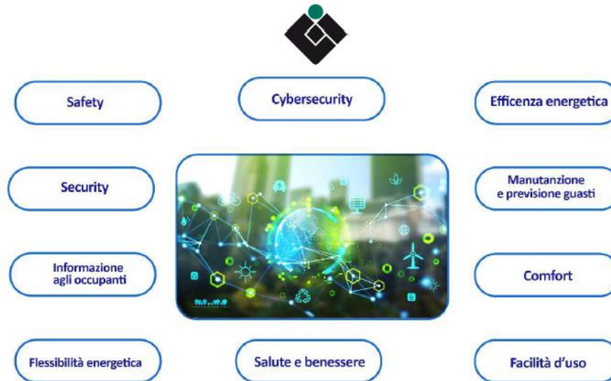
Figura 1: Criteri di impatto principali di uno Smart Building (in grassetto vengono identificati i criteri di impatto presenti nella metodologia per il calcolo dello Smart Readiness Indicator)
