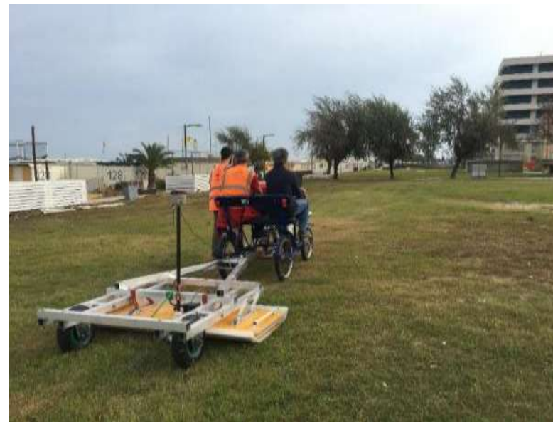
Acquisizione dati mediante sistema ad array complesso
