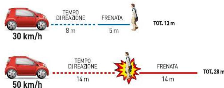
*distanza di arresto in funzione della velocità*
