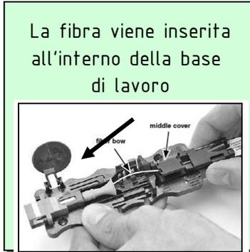
La fibra viene fatta scivolare all'interno di una guida a "V"
