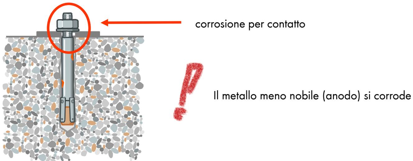
Metalli con diversa potenzialità a contatto elettrico in presenza di un elettrolita
