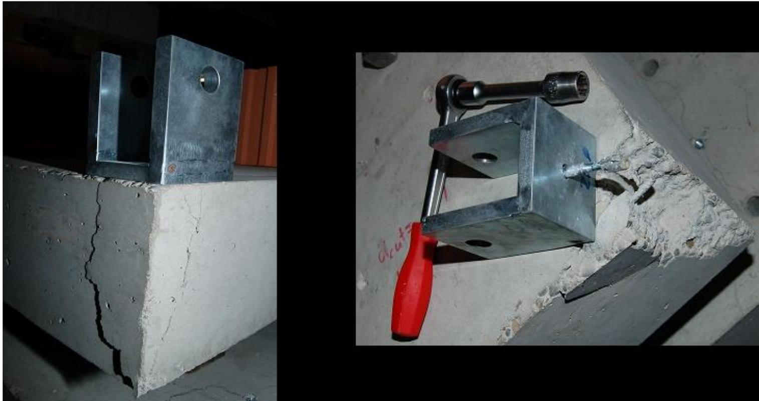
Coppia di serraggio troppo elevata - rottura del supporto in prossimità del bordo
