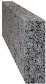
LMC Legno Mineralizzato \lambda_d = 0,065 \text{ W/(mK)} Euroclasse B-s1,d0
