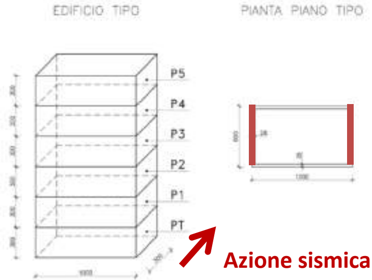
Figura 3.19. Schemi edificio analizzato
