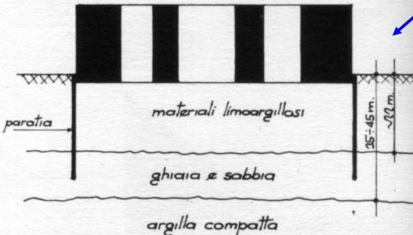
Fig. 11: Stabilizzazione della falda.
