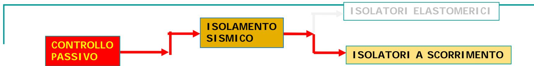
Gli isolatori a scorrimento (o quelli a rotolamento) sono costituiti da appoggi a scorrimento (**acciaio-teflon**) o a rotolamento (**su rulli o sfere**), caratterizzati da **bassi valori delle resistenze di attrito**.
