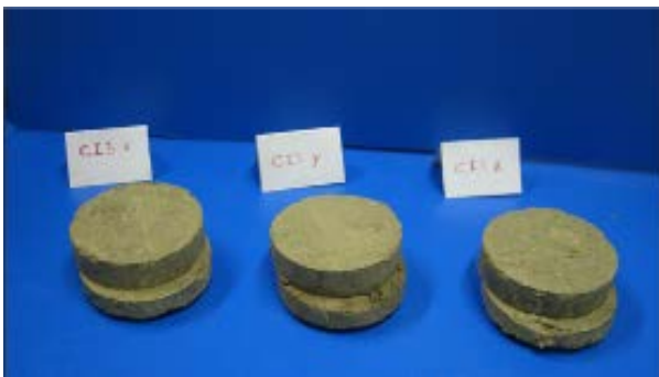
Figura 20 – provini CI3 x,y,z per la prova di taglio diretto.
