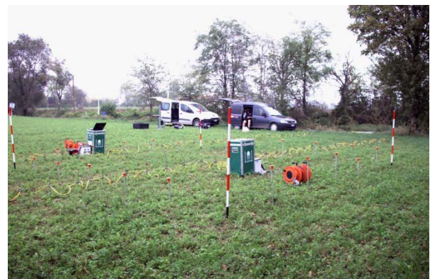
Figura 3 – Il campo prove - indagini di tomografia della resistività elettrica (2009, Geostudi Astier ITA).
