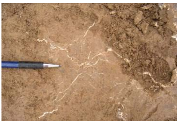
Figura 27 – Reticolo capillare di resina nel terreno che evidenzia una micro fratturazione indotta dall'espansione meccanica del formulato chimico.
