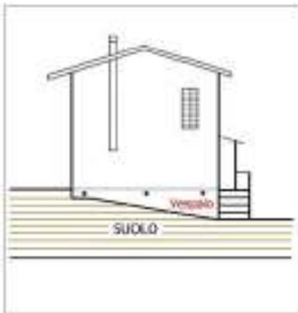
Le pareti sono in laterizio e attorno all'abitazione è presente un marciapiede. Il lato est è privo di aperture. I telai delle finestre sono in legno e dotati di vetrocamera e di guarnizioni a tenuta, mentre le ante sono in legno a battente normale a due sportelli. Il solaio a terra prevede un getto di calcestruzzo e successivo massetto di pavimentazione: si trova sopra un vespaio ventilabile riempito da macerie derivanti dalla demolizione della precedente costruzione.
