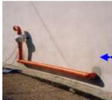
I due tubi sono stati raccordati e collegati con un ventilatore centrifugo assiale della potenza di 65 W; un breve tratto di tubo verticale completa l'impianto. La posizione del ventilatore è centrale rispetto alla lunghezza dell'intero impianto di tubazioni.
