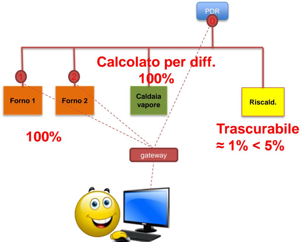
In totale sono stati installati 2 contatori + 1 acquirente digitale per il PDR. I consumi della caldaia vapore vengono determinati per differenza tra il consumo del PDR e quello dei Forni.
