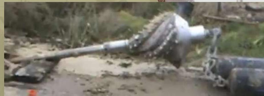
Ruotando grazie al moto trasmesso dalle aste, esercitano un'azione fresante e quindi allargante sul foro sempre coadiuvati dai getti di fango per l'asportazione del terreno e la stabilizzazione delle pareti del foro
