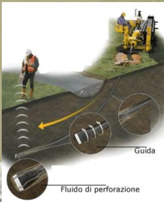
La perforazione avviene mediante erosione del terreno per mezzo di acqua e/o fanghi che, passando attraverso le aste di perforazione, fuoriescono ad alta pressione dalla testa di perforazione.
