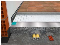
20mm di massetto Knauf NE 425 sopra Tubazione
