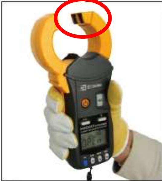
Lo strumento è dotato di un **doppio toroide sovrapposto**, il primo induce una corrente, il secondo misura la corrente effettivamente circolante.
