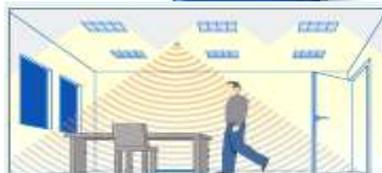
Presenza rilevata, nessuna luce esterna - luce accesa con potenza massima
