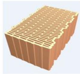
POROTON ECO EVOL MVI 410 n. 33 File di camere; 4 incastri
