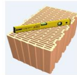
POROTON ECO PLAN EVOL MVI 410 R n. 33 File di camere; 4 incastri; rettificato
