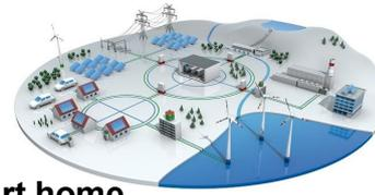
>> **Smart Buildings** : edificio come nodo di produzione locale di energia , di dispacciamento locale e di vendita , di accumulo dell'energia e di stabilizzazione della rete
