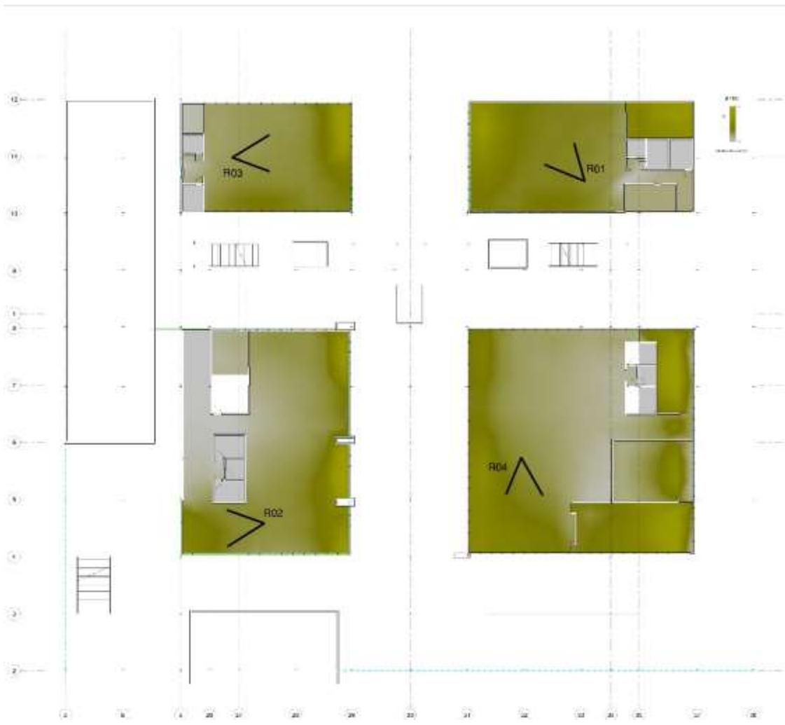
Simulazione Analisi Illuminamento - luce naturale -( lux).
