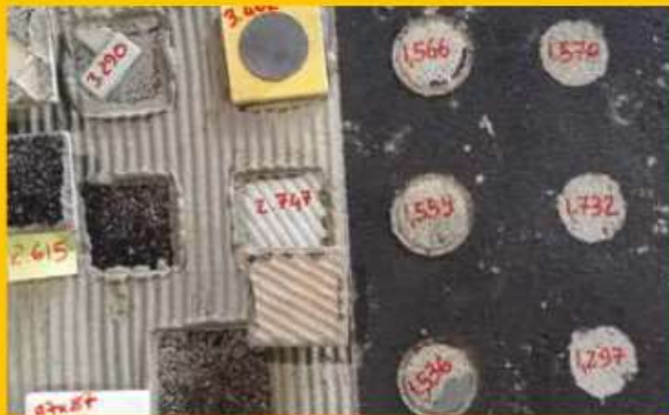
Prove di trazione diretta eseguite su numerosi provini in Leca con diverse tipologie di sistemi di impermeabilizzazione.
