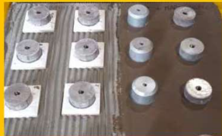
Prove di trazione diretta eseguite su numerosi provini in Leca con diverse tipologie di sistemi di impermeabilizzazione.
