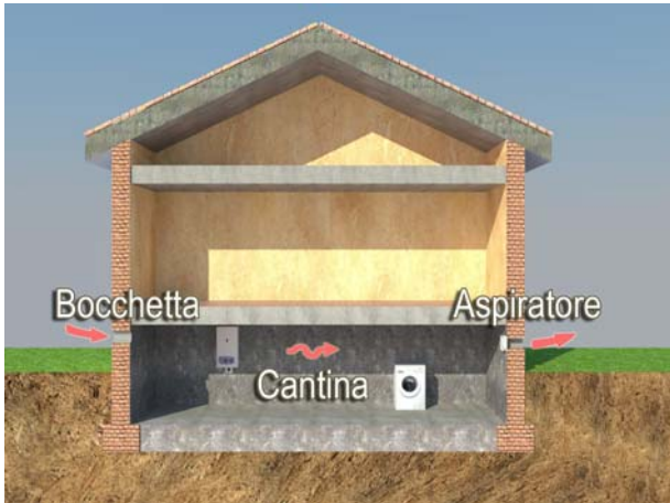
Schema dell'intervento di ventilazione forzata delle cantine.
